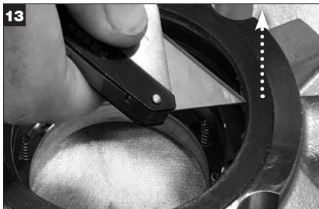
Plochu tesnenia hriadeľa vyberte z príruby a zlikvidujte.
